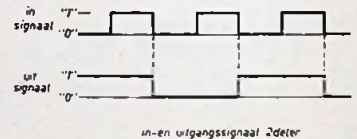
Fig. 19d - Het in- en uitgangssignaal van de tweedeler. Het uitgangssignaal verandert als de clock-puls (in) van '1' naar '0' gaat.
